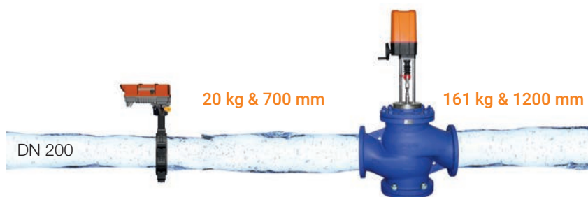
2cestná mezipřírubová klapky ve srovnání s 2cestným zdvihovým ventilem.
